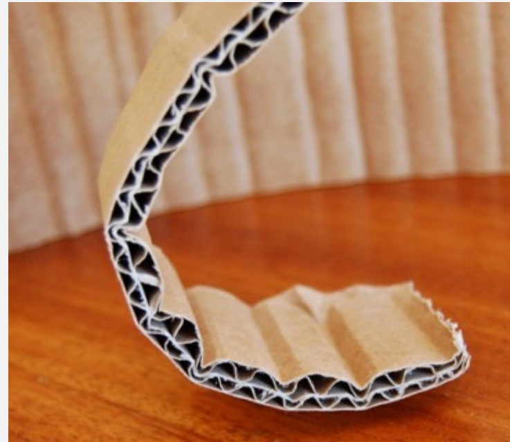
Gambar perlakuan tekukan dan lengkungan bidang mengikuti arah dari tekstur material
